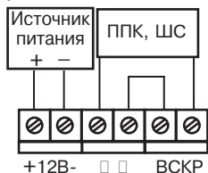
Рисунок 3 – Схема подключения извещателя с объединенными шлейфами сигнализации и вскрытия корпуса
